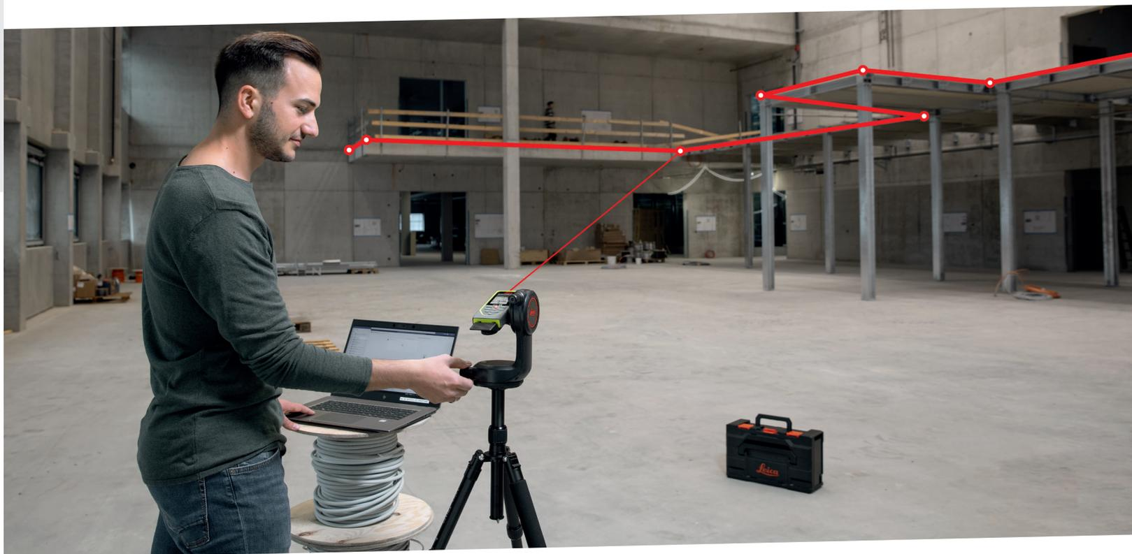
La tecnologia P2P rappresenta un metodo di misura sicuro, accurato ed efficiente per misurare la distanza in aree inaccessibili o in situazioni di misura complesse. Inoltre, consente un flusso di lavoro completamente digitale, in quanto i risultati di misura acquisiti possono essere ulteriormente elaborati in qualsiasi software CAD.
