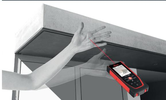
Con l'attivazione della misura senza contatto, interrompendo brevemente il raggio laser con la mano, Leica Geosystems risolve un problema molto diffuso, ovvero lo spostamento del distanziometro laser durante l'attivazione della misura. Evitare questa situazione risulta particolarmente importante per ottenere risultati precisi anche in caso di distanze elevate o target di piccole dimensioni.
